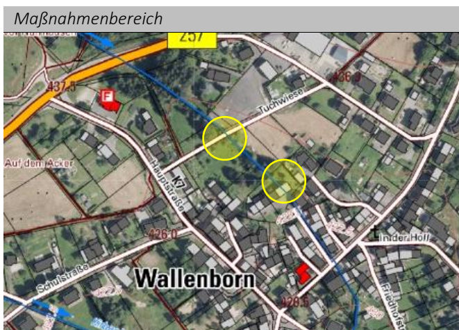
Abflussweg zur Hauptstr. bei Überlastung der Verrohrung
