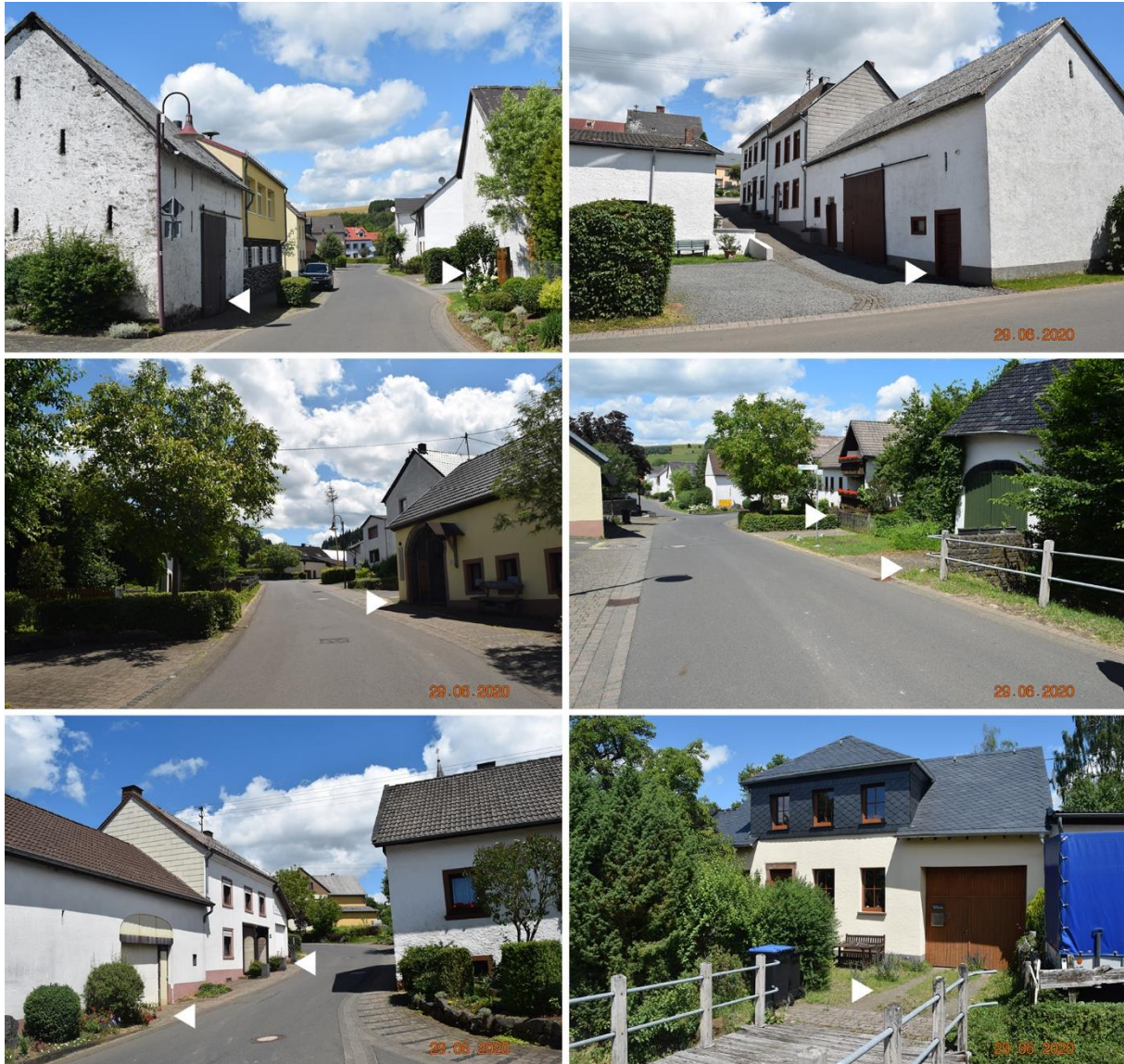
Abbildung 6: Gefährdete Gebäudeöffnungen bei Wasserabfluss entlang der Straßen „Zum Ernstberg“ und Hauptstraße – beispielhafte Darstellung
