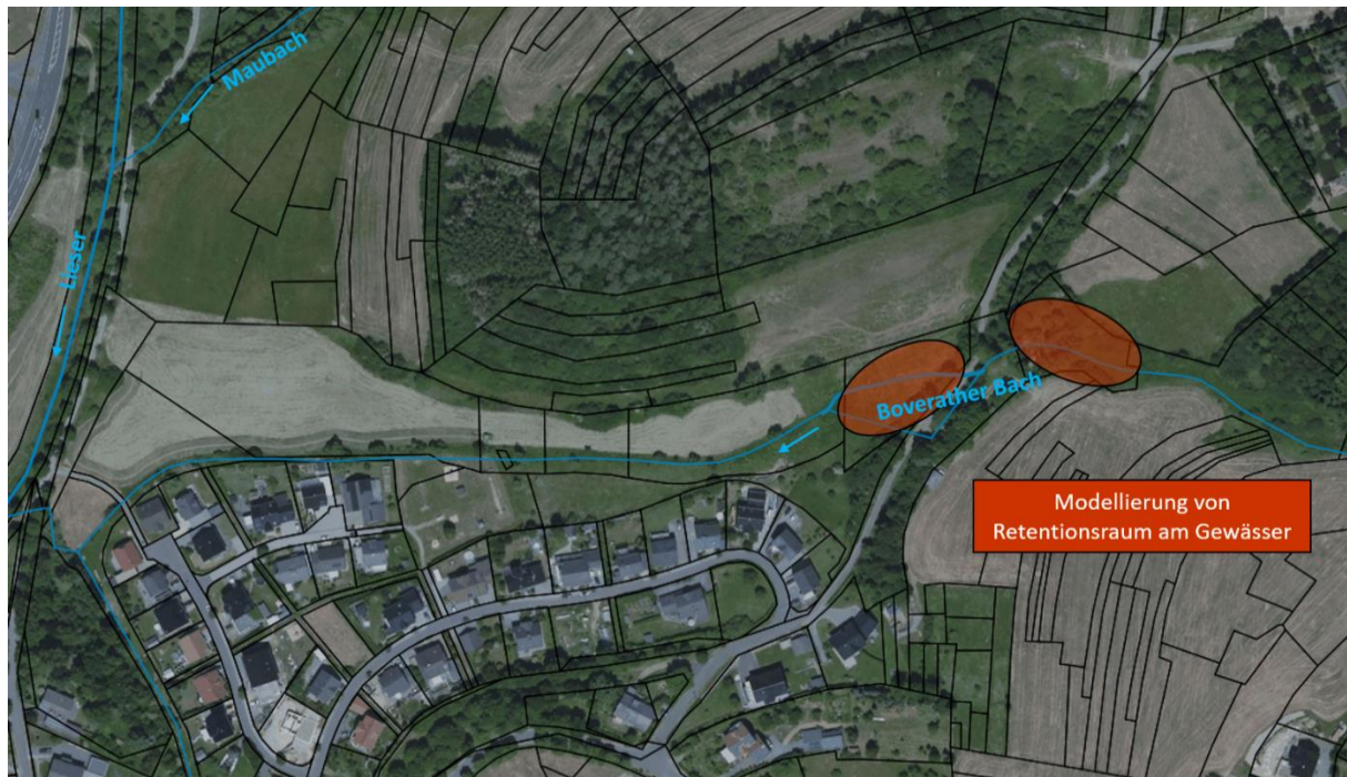
Abb. 20: Erweiterung des Retentionsraumes am Boverather Bach
