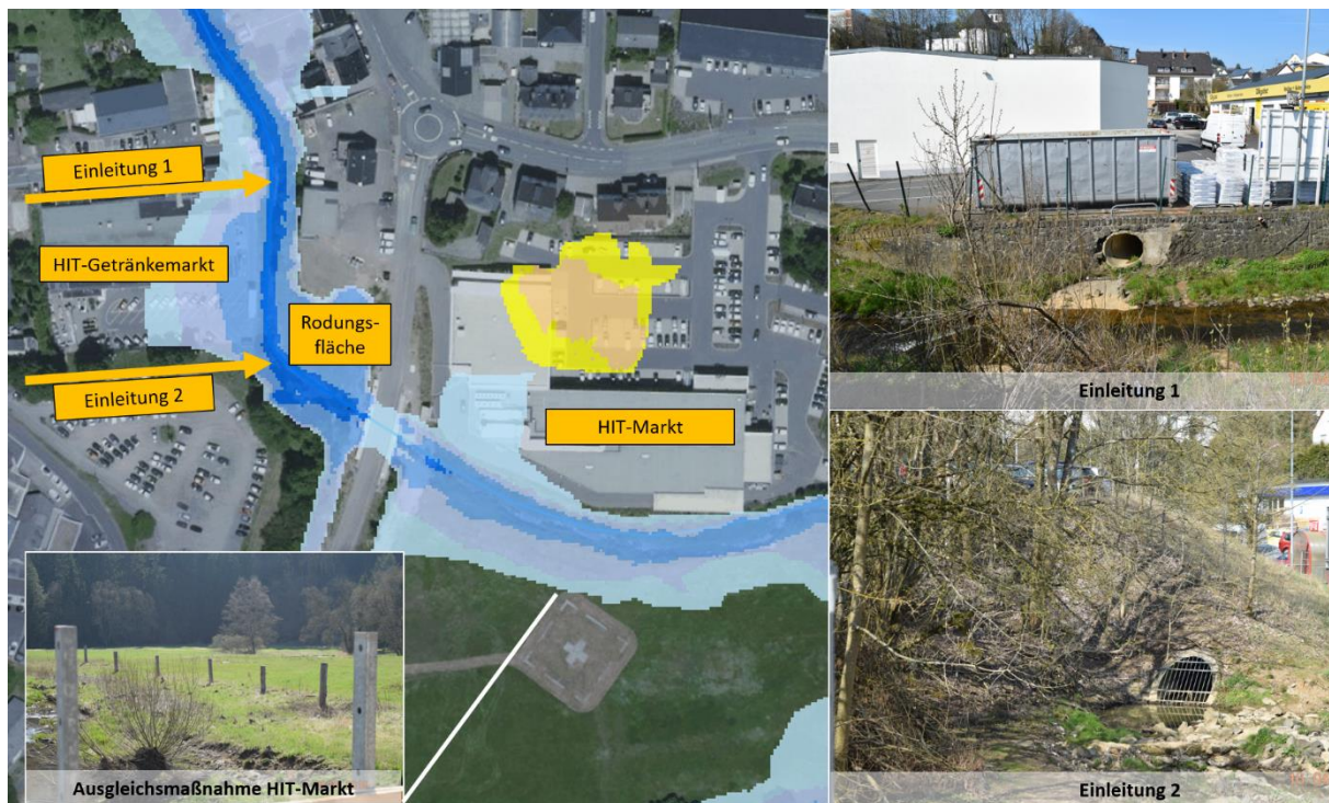
Abb. 27: Überschwemmungsbereich HQextrem im Bereich des HIT-Marktes
