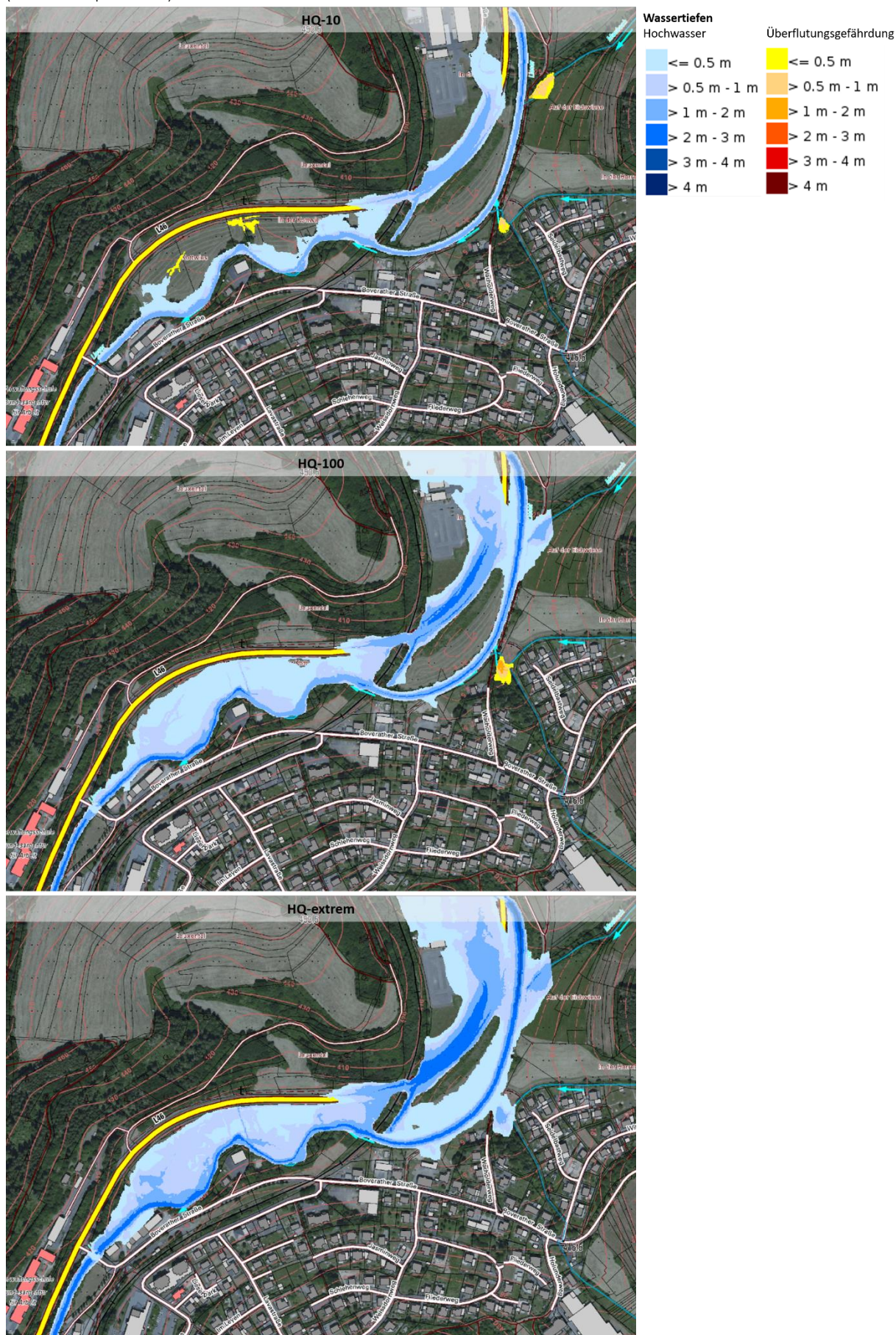
Abb. 6: Ortslage Boverath: Überschwemmungsgebiet bei HQ 10, HQ 100 und HQ extrem (Quelle: Geoportal RLP)
